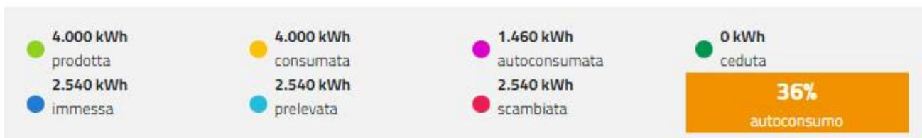
Nell'esempio mostrato in figura, a fronte di un consumo annuo di 4.000 kWh, grazie all'autoconsumo dell'energia prodotta dall'impianto fotovoltaico verrà riportato nelle bollette un prelievo complessivo annuo di 2.540 kWh e quindi si avrà un risparmio su 1.460 kWh.
