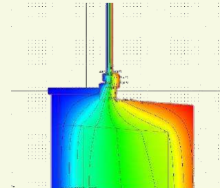
Particolare stato di fatto - Spalletta non isolata
