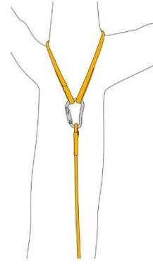
Fig. 5 - Ancoraggio della fune con dispositivo passante
