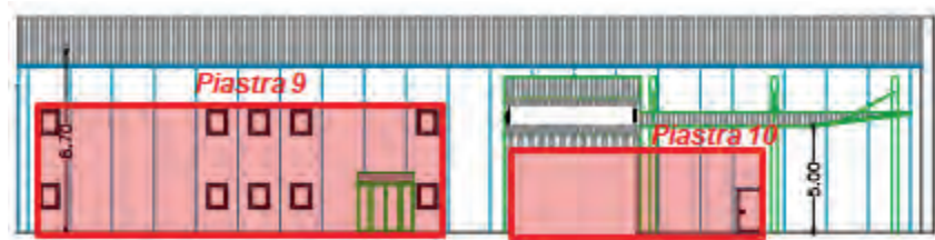
PIASTRE RADIANTI PR9 E PR10 - PROSPETTO OVEST
