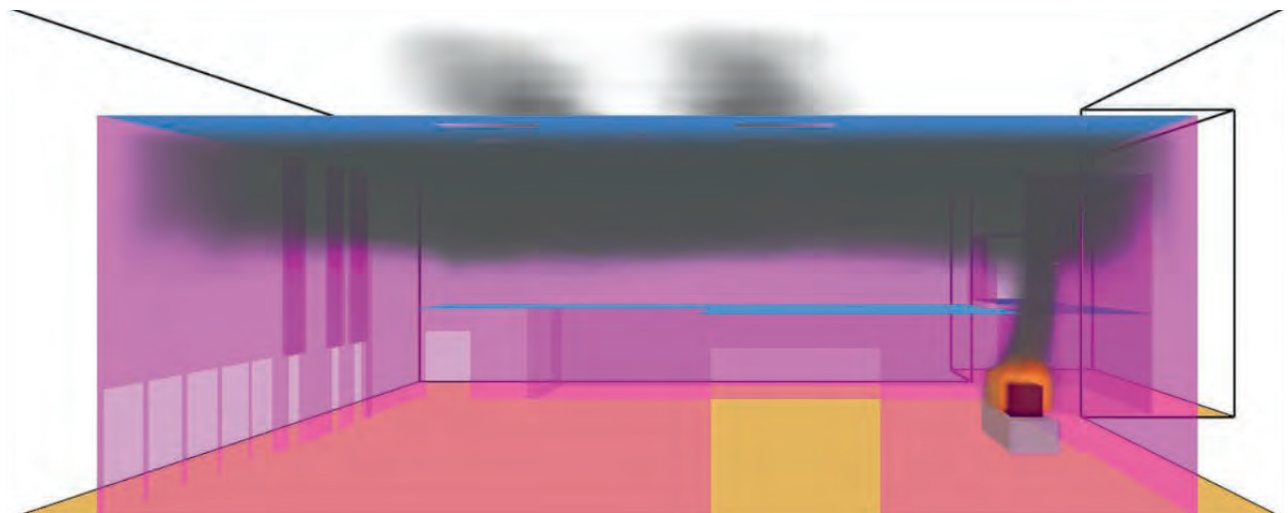
SCENARIO A - PROPAGAZIONE DEI FUMI DOPO 2700 s
