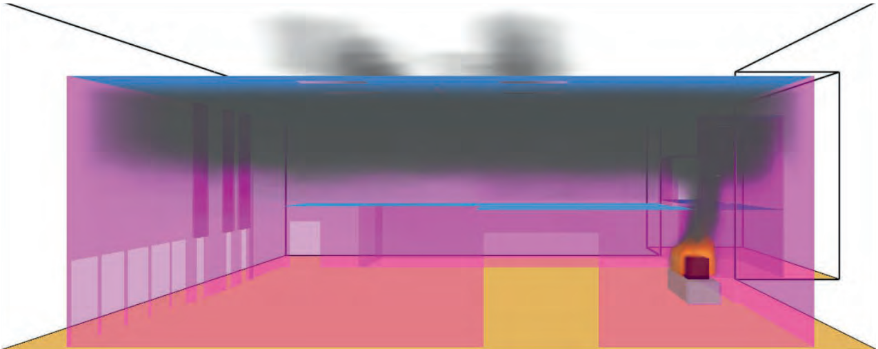
SCENARIO A - PROPAGAZIONE DEI FUMI DOPO 300 s
