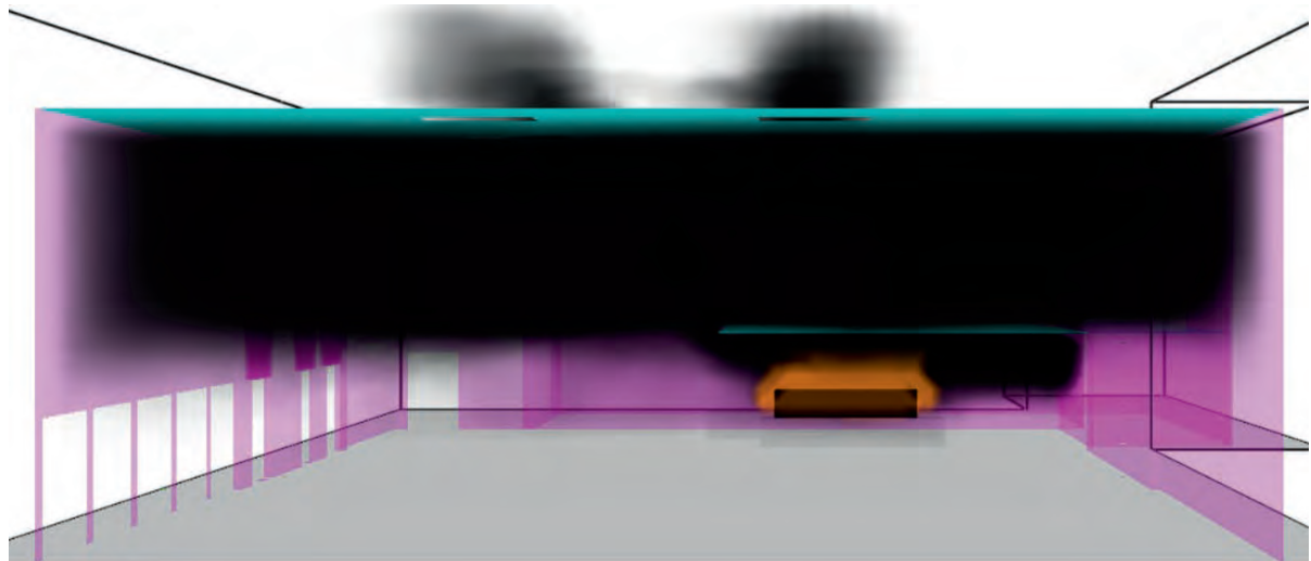
SCENARIO C - PROPAGAZIONE DEI FUMI DOPO 1800 s
