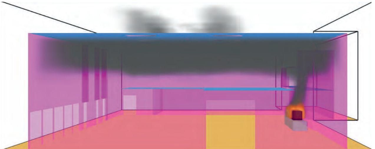
SCENARIO A - PROPAGAZIONE DEI FUMI DOPO 1800 s
