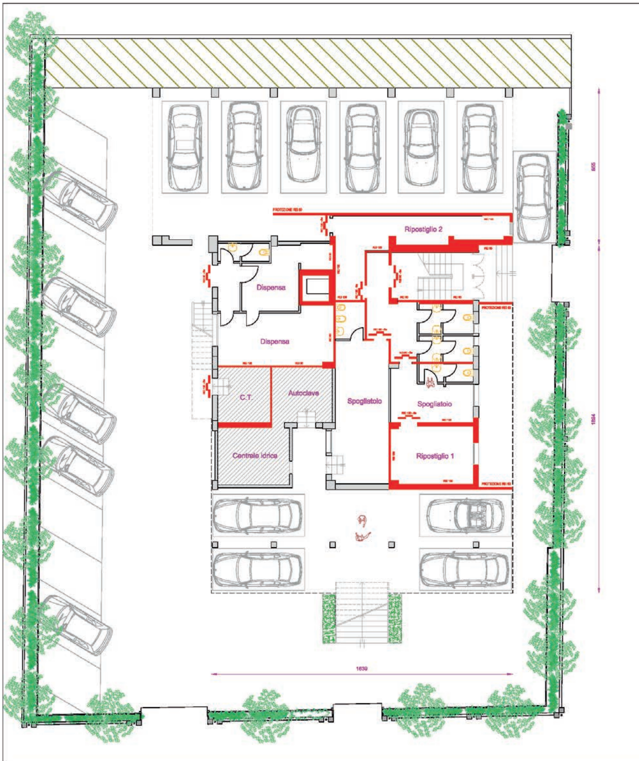
COMPARTIMENTAZIONE DEL PIANO SEMINTERRATO
