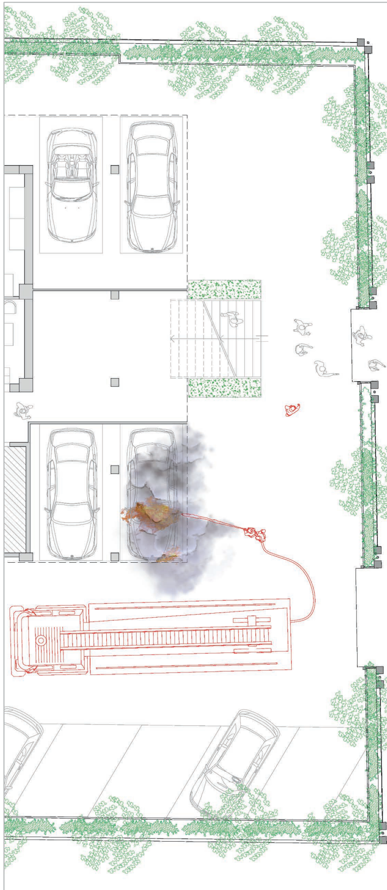
INTERVENTO DEI V.F. SU UN'AUTO INCENDIATA
