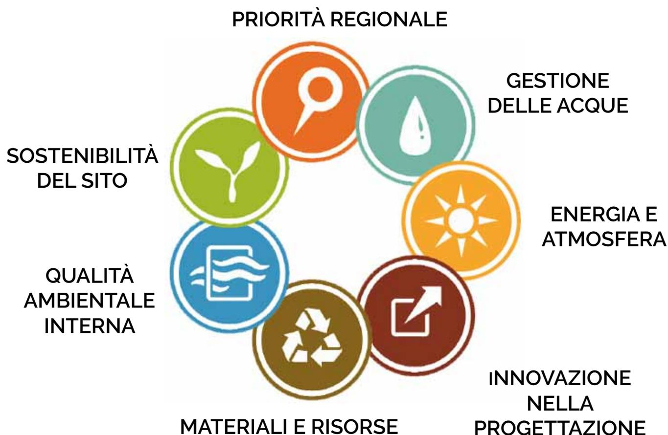
Il sistema di rating LEED® si struttura in 7 sezioni organizzate in prerequisiti e in crediti. I prerequisiti di ogni sezione sono obbligatori affinché l'intero edificio possa venire certificato; i crediti possono essere scelti in funzione delle caratteristiche del progetto.
