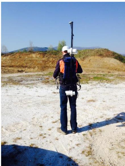
**magnetometro con gradiente e GPS per restituzione grafica georeferenziata delle anomalie ferromagnetiche rilevate**
