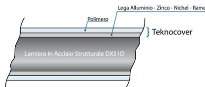
L'acciaio ha ottime caratteristiche di resistenza meccanica ma ha scarsa resistenza agli agenti atmosferici quali aria e acqua e quindi ha bisogno di essere adeguatamente rivestito. Il trattamento più utilizzato per la protezione dell'acciaio dall'ossidazione e dalla corrosione è la zincatura.
