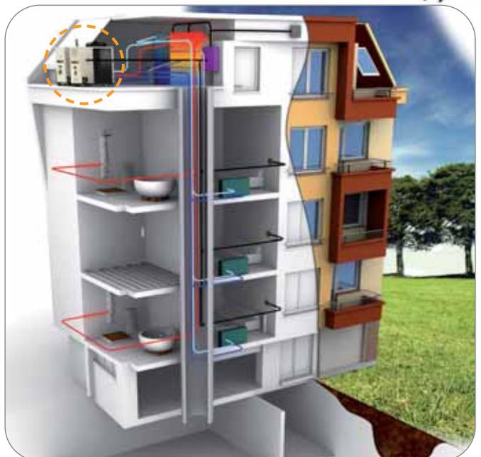
Esempio di applicazione GAHP-AR in funzionamento invernale e estivo con impianto a pannelli radianti, fancoils, produzione indiretta ACS.
