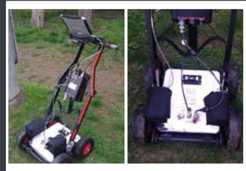
Strumento utilizzato: Georadar Hi Mode IDS
