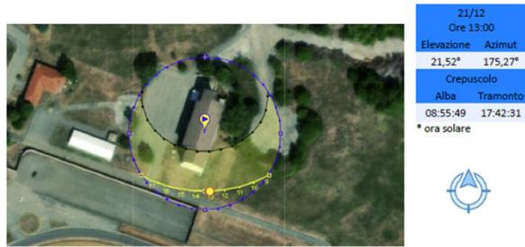
Figura 6 : irraggiamento solare solstizio d'inverno 21 dicembre ore 13:00
