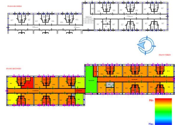
Figura 9 : planimetria dell'edificio con indicazione delle dispersioni totali per trasmissione
